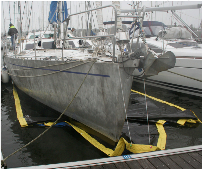
Mise en place du parefouling autour de la coque
